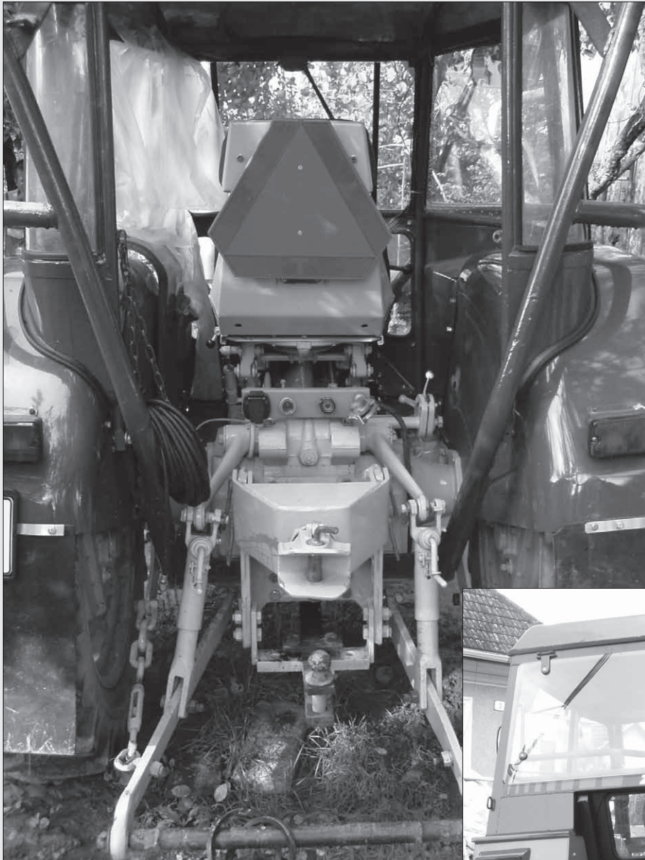
Hydraulika Zetomatic a Zetor 3011 z roku 1962
