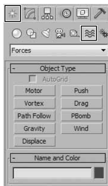
Obrázek 2.44. Prostorové deformace (Space Warps) jsou zvláštní kategorií objektů, jejichž úlohou je působit na ostatní geometrické objekty určitou silou či deformací
