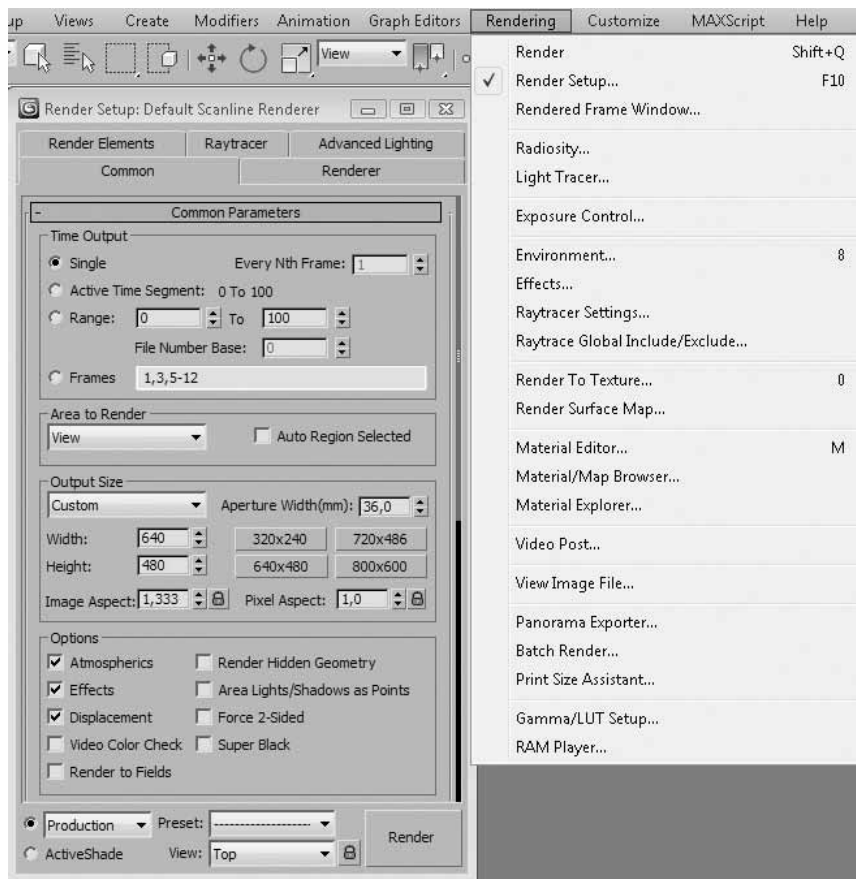
Obrázek 2.37. V nabídce Rendering najdete příkazy pro nastavení výstupního formátu a kvality renderování
