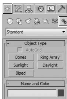
Obrázek 2.45. Poslední kategorie objektů – Systems – obsahuje pokročilejší objekty složené z některých základních. Pro osvětlení například využijete denní osvětlení Daylight, které se skládá ze slunečního světla a nebeské klenby.
