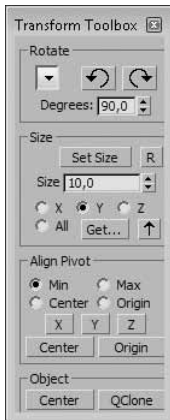
Obrázek 2.9. Dialog Move Transform Type-In nabízí možnost zadání souřadnic X,Y a Z pro posun objektu. Máte na výběr mezi absolutními souřadnicemi (na které místo chcete objekt přemístit) nebo offsetovými souřadnicemi (o kolik jednotek z aktuálního místa se objekt posune) ❶. Transformace můžete také provádět pomocí nástroje Transform Toolbox ❷.
