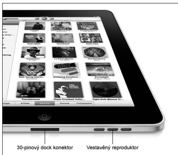
Obrázek 1.4: Spodní strana iPadu obsahuje nejen reproduktory, ale také pro chod přístroje zcela zásadní konektor.
