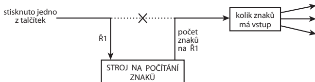
Obrázek 1.13. Schéma předávání informací: program slovníku předá stroji na počítání znaků (jako jeho vstup) řádek, o který mu jde, a stroj mu za chvíli vrátí počet znaků na daném řádku. A program slovníku pak může dál pracovat (přesunovat se do dalších svých stavů).
