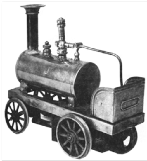
Z roku 1884 je model bezkolejové lokomotivy poháněné kývavým parním strojem, který vyráběla firma Carette
