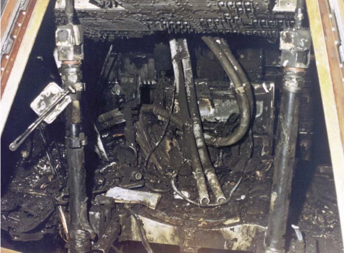
Detailný pohľad do kabíny Apollo po tragickom požiari.
