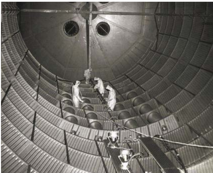
V nádrži kvapalného kyslíka na prvom stupni Saturnu V boli štyri valcovité nádrže hélia, pričom každá mala dĺžku 5,5 metra.
