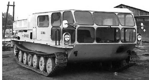
Sklápěcí vůz na podvozku BTR-50PK vyrobený ve VOP 026 Šternberk [5]
