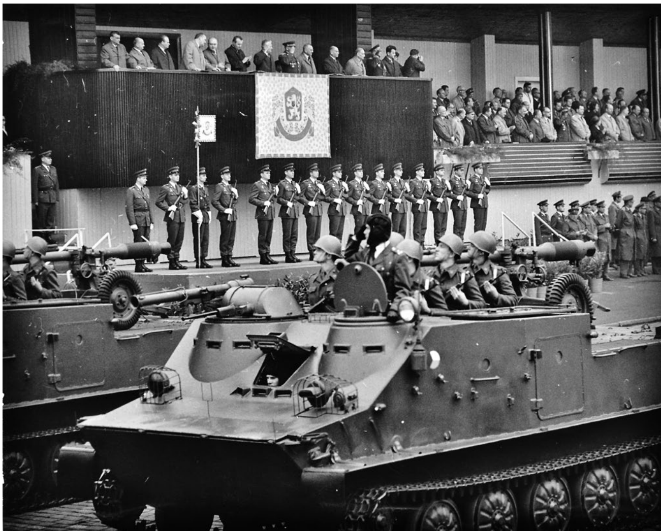
Transportéry OT-62A s naloženými 82mm BzK vz. 59A při vojenské přehlídce 9. května 1966 v Praze na Letné. Pro udržení správného směru měl řidič před očima v místě vlnolamu drátěný zaměřovač, kterým sledoval na dlažbě namalovanou bílou čáru
