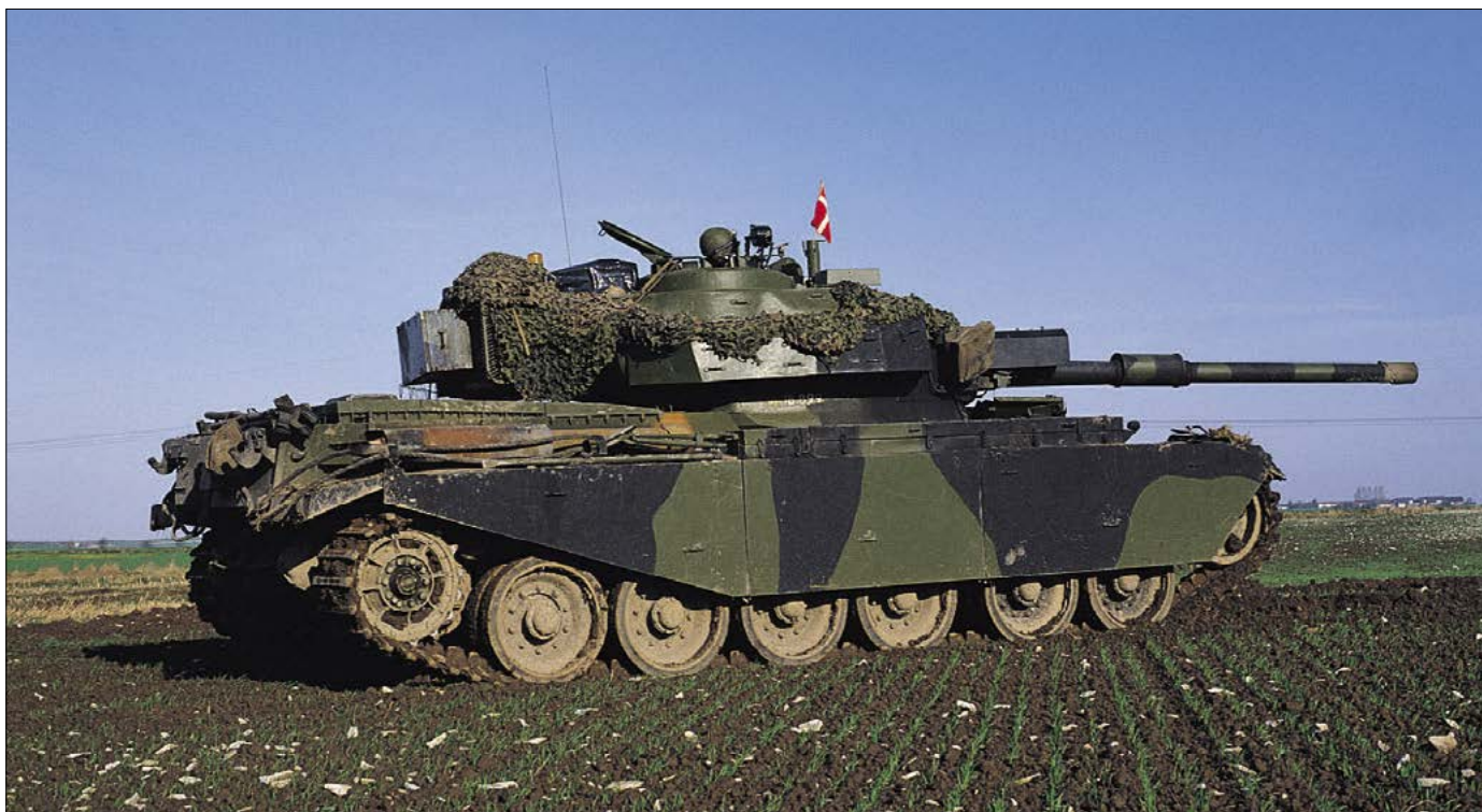
Britský tank Centurion v evropském kamuflážním schématu čeká během cvičení na rozkazy. Pověšněte si pancéřových desek chránících pásy a kola proti střelám a minám.
