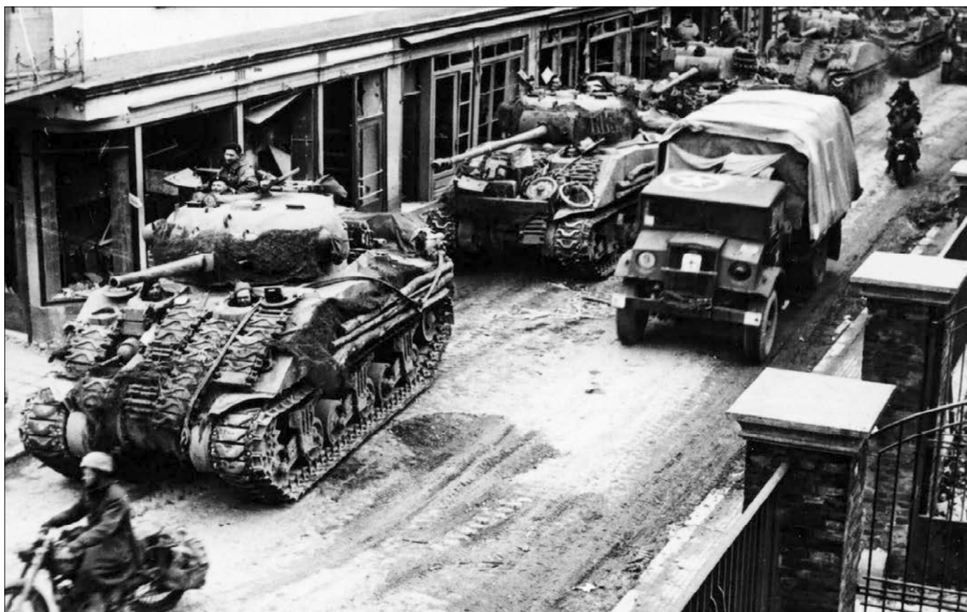
Zastávka kolony tanků M4 Sherman během průjezdu městem. Druhý tank v koloně je vyzbrojen výkonnějším sedmnáctiliberním kanónem (ráže 76,2 mm), první stroj má ve věži původní kanón ráže 75 mm.
