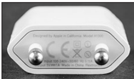
Obr. 1 Informace výrobce – označení CE spolu s dalšími označeními, která se na výrobek vztahují
