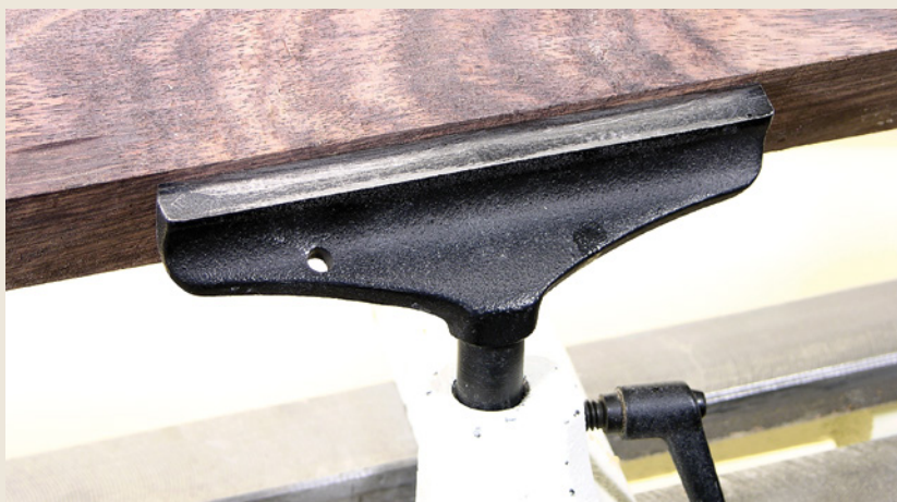
1.13 Všímněte si, jestli dřevo naráží do opěrky nástroje. To se nesmí stát! Obrobek se v takovém případě poškodí a jeho ulomené části vás mohou zranit.
