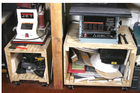
1.21 Vlevo je oscilační bruska a vpravo frézka. Kvůli úspoře místa je vhodné namontovat stroje na skřínky s brzděnými kolečky, abyste se je mohli v případě potřeby přivést a poté opět vrátit pod ponk.
