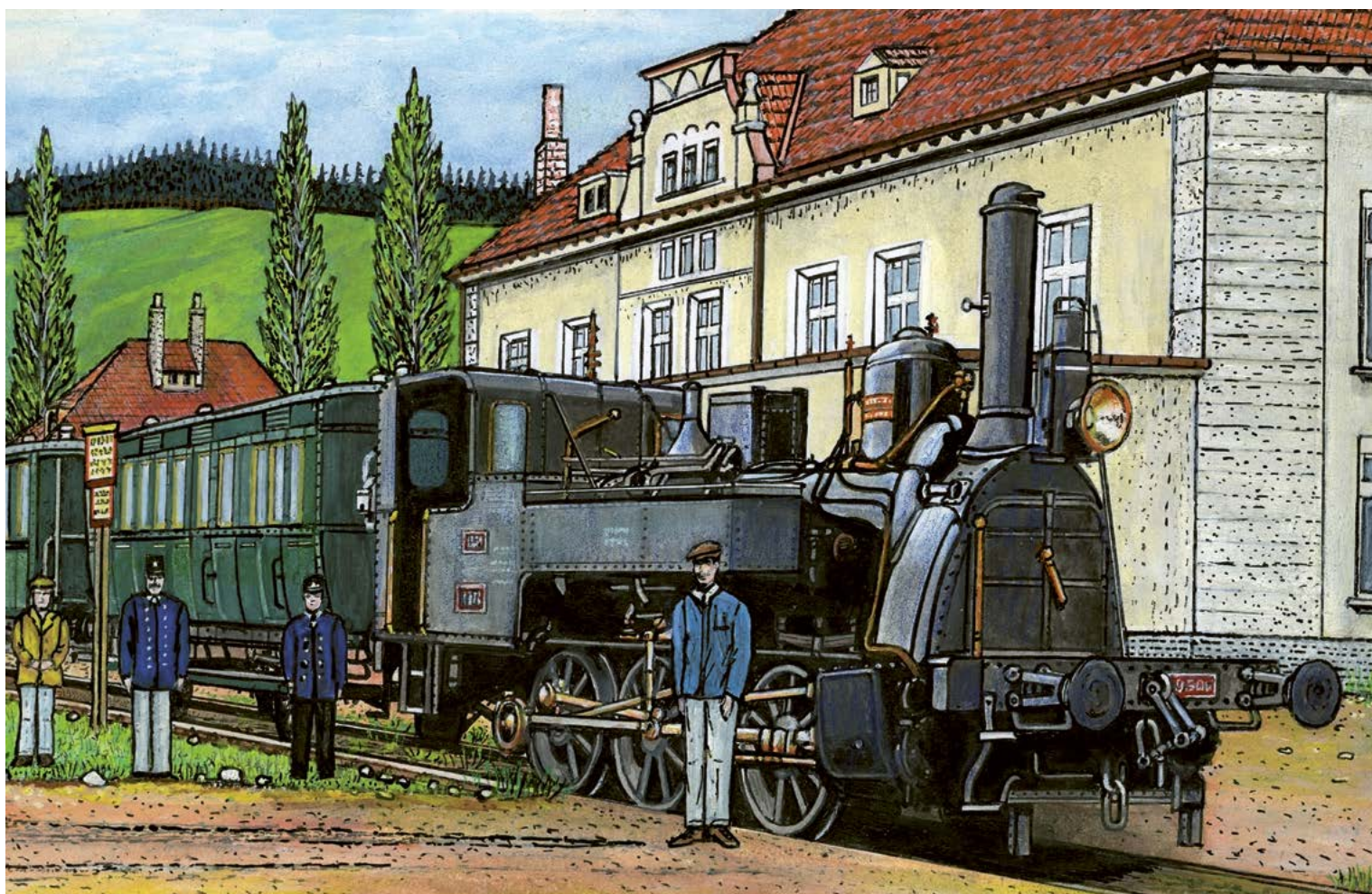
Parní lokomotiva původně IV. c u ČSD řada 300.4
