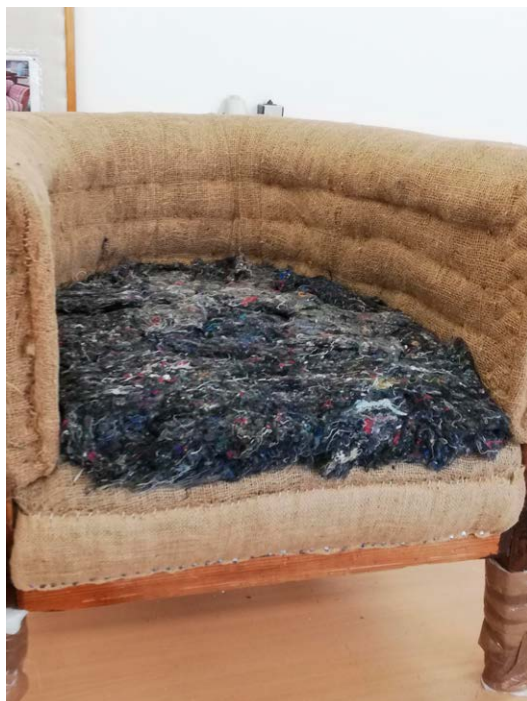
7 Po obsednutí, utažení prošívacích stehů a přišití řídké juty k jutě hustě následuje naložení čalounické vaty
