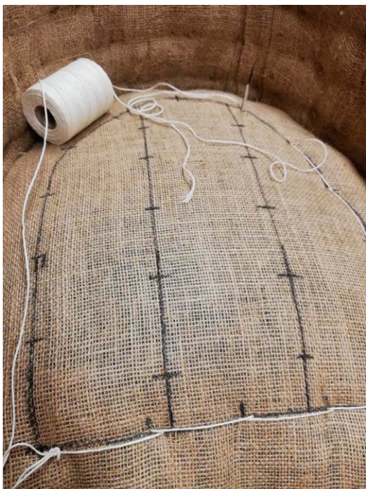
6 Prošívání pomocí dvouhrotové jehly
