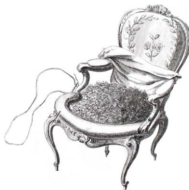
13 Částečně potažené křeslo s přední částí s hranovou tvárnici (purle) od područky k područce, sedací plochu dutého čalounění vyplňují koňské žíně; potahová textilie s vyšitými florálními motivy
