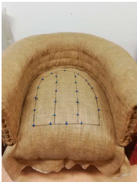
5 Překrytí africké trávy jutou řidkou (tvarovacím plátnem) a označení bodů k prošití
