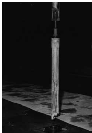
Přepálený paliivový článek po vytažení z reaktoru.
