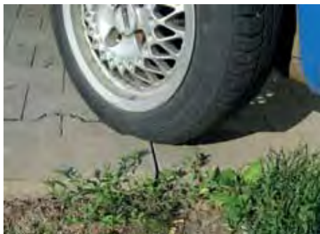
Riziko poškození pláště: špatné parkování na obrubníku
