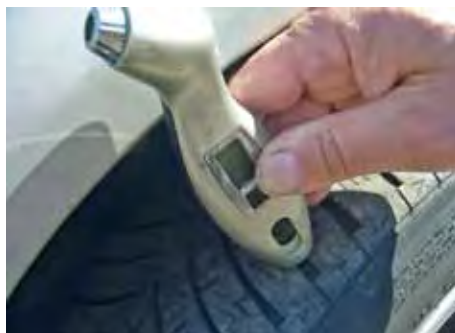
Měření hloubky vzorku pneumatiky
