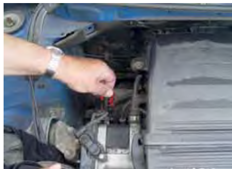
Umístění olejoměry v motorovém prostoru
