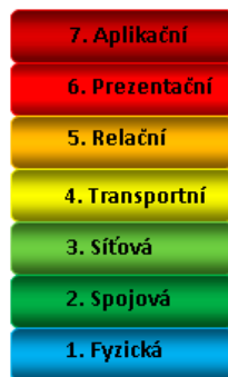
Obrázek 1.4: Sedm vrstev modelu ISO/OSI
